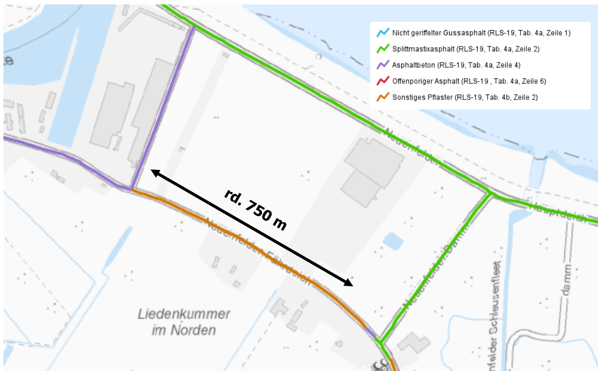
Abbildung 13: Straßendeckschichttypen (BVM, 2023)
